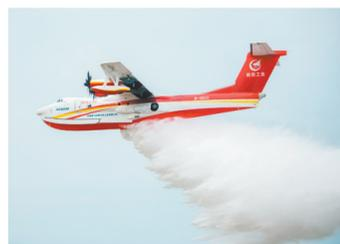
9月27日，“鲲龙”AG600M在进行飞行投水功能演示。当日，由我国自主研制的大型水陆两栖飞机“鲲龙”AG600M，以全新红色消防涂装在湖北省荆门市漳河机场完成12吨投汲水试验。新华社发
