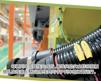
每辆列车在接线完成后，接线员的实名标签就被捆扎在线束上，和这条线束共同守护列车的正常运行。
