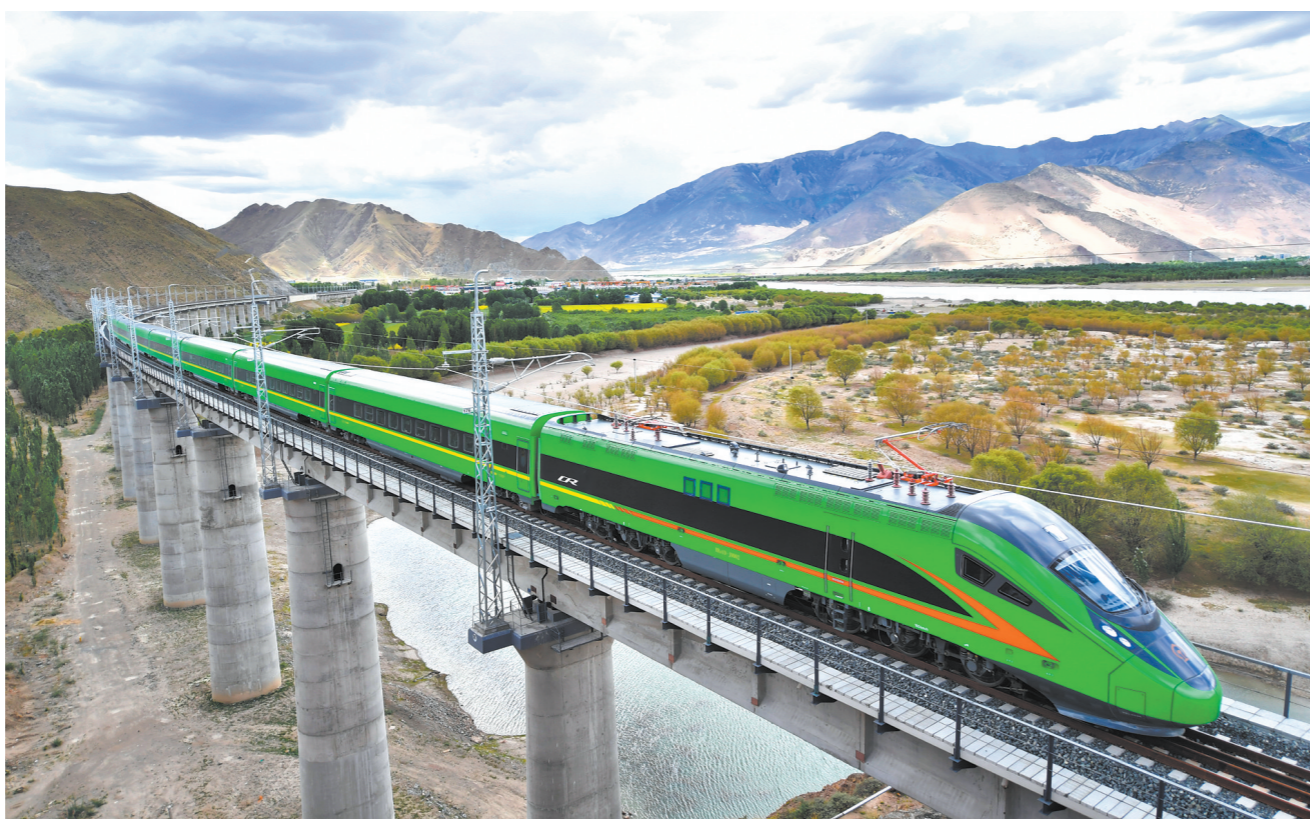
2021年6月25日,全长435公里、设计时速160公里的拉林铁路建成通车,西藏首条电气化铁路建成,同时复兴号实现对31个省区市全覆盖。这是试运行的复兴号列车行驶在西藏山南市境内(2021年6月16日摄)。
