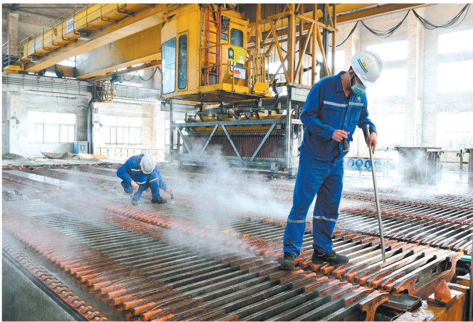
1月28日,工人在安徽铜陵有色金属(集团)公司金隆铜业有限公司电解车间生产电解铜。新华社发
