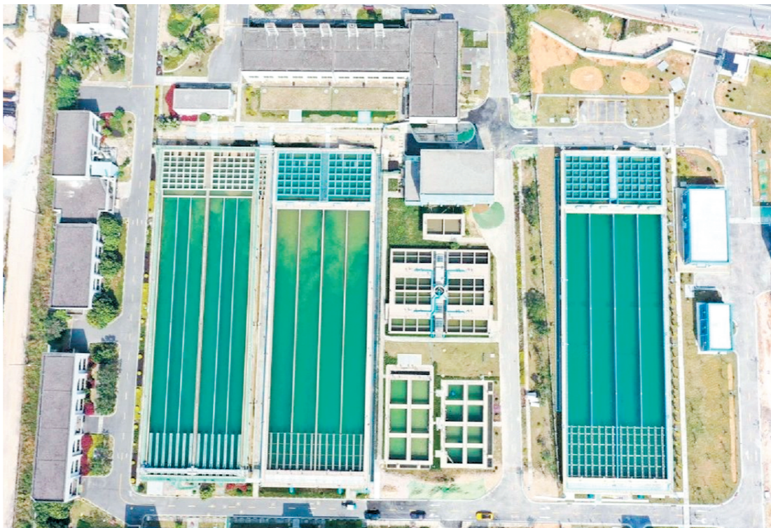
鹤山市第三水厂包括净水厂和水源厂两个厂区，其中，净水厂设计每天供水规模为9.5万立方米，经检测，出厂水水质优良，优于国家卫生标准。
