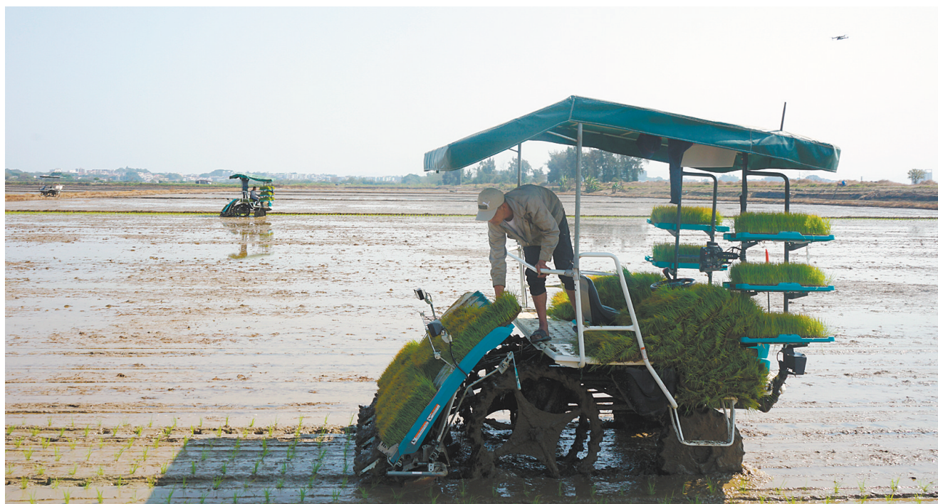
和传统高速插秧机相比,无人驾驶插秧机不需要驾驶员,只需一人放秧。图为农户在无人驾驶插秧机上放秧。
