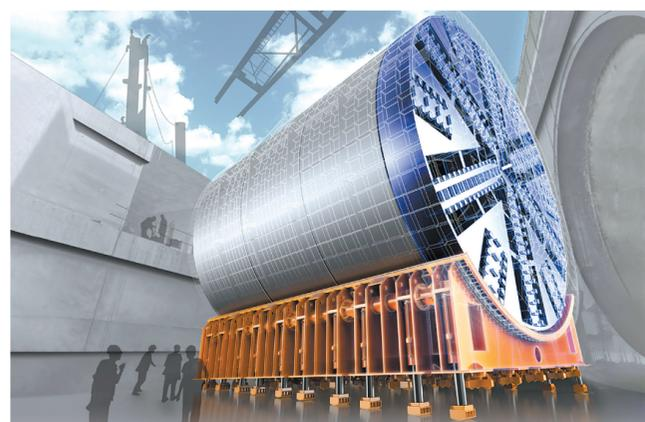
“大型盾构机盾体一体平移转体系统及解决方案”破解了传统大型盾构机只能直线和大曲率线性运动局限性导致的工位调整难题。
