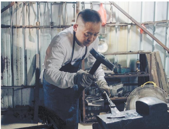
打造一把剑要经过锻打、锉磨、淬火、磨砺等工序。图为陈再荣在锻打铁块。
