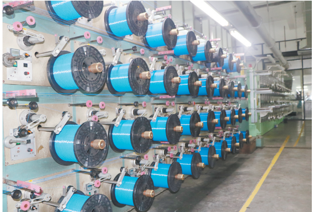
新华胶丝厂主营产品为造纸过程中所用的耗材胶丝，其核心品种聚酯单丝和尼龙单丝年产量超2500吨。
