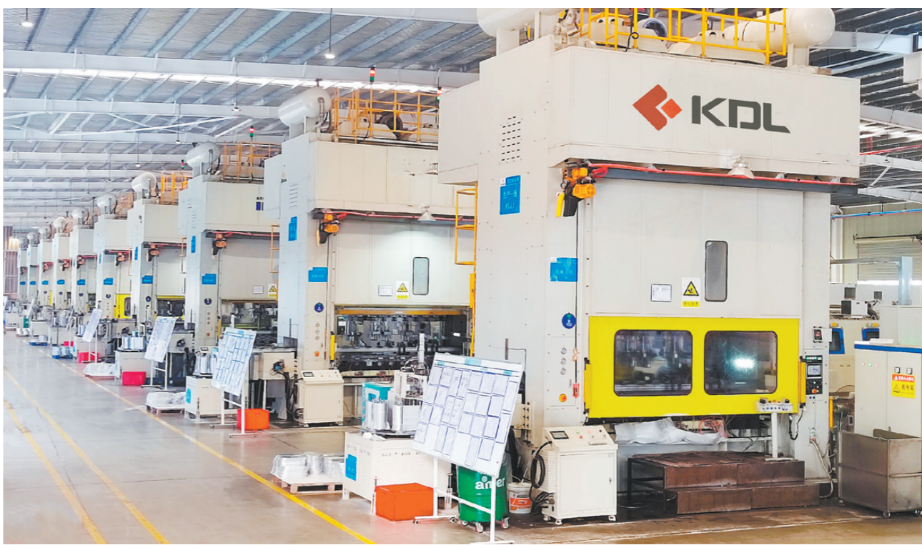
江门科达利新能源电池铝壳自动生产线。
