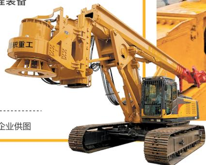
▲厚积重工生产的HR460旋挖钻机。
