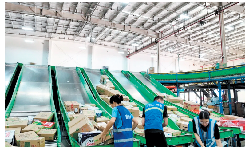
11月以来,鹤山珠西国际物流中心各大物流仓储中心一片繁忙,物流分拣中心内的全自动分拣线高速运转。
