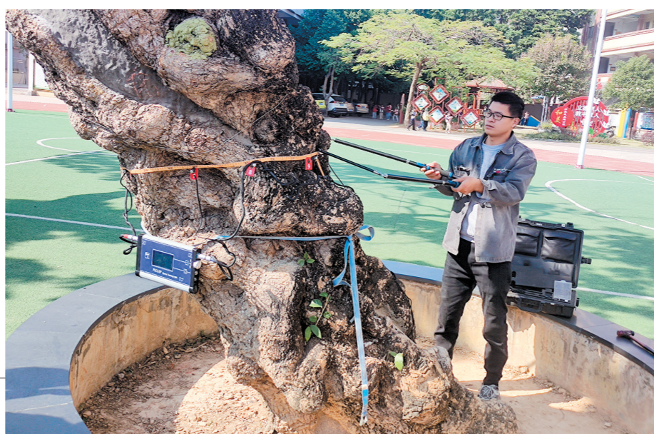
技术人员对古树进行弹性波树木断层成像诊断。
