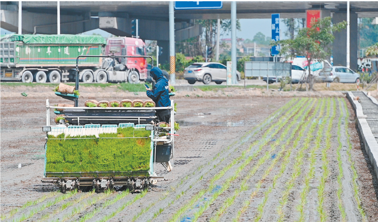
随着机器开动，秧苗按照设定好的间距和深度被整齐地插进田间。
