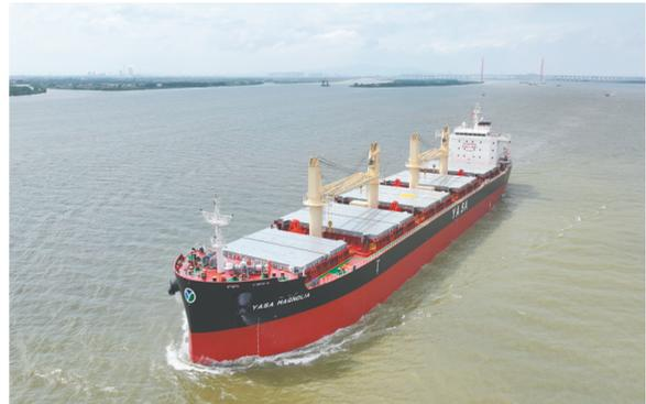
南洋船舶主打的40500DWT敞口型节能环保散货船,如今在其所属的小灵便散货船细分领域中,市场占有率位居全球造船厂首位。 皇智尧 摄
