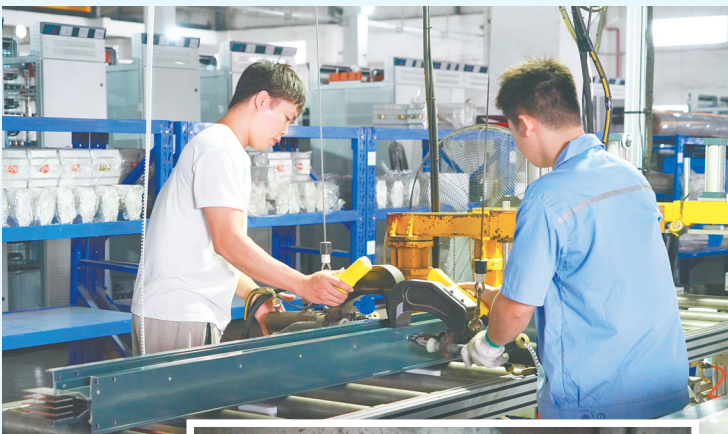
▲在生产车间，工人正在进行母线槽铆接。
