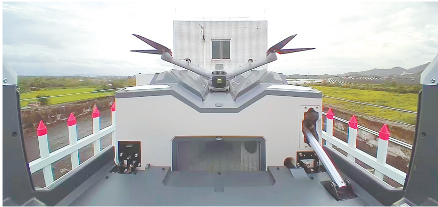
南方电网广东江门开平供电局启用机巢无人机,实时传回杆塔倾斜、导线断股等故障画面,大幅缩短查障时间。
