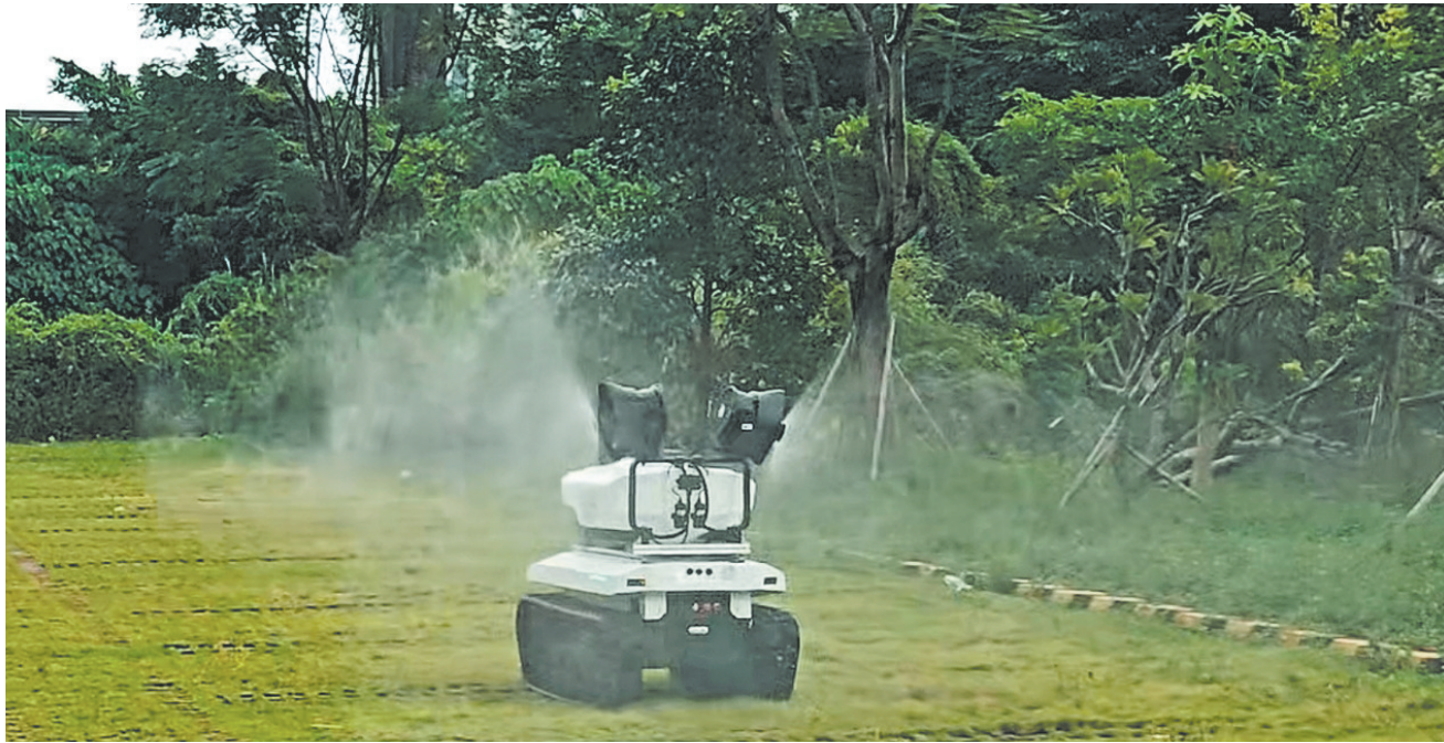
江门产研院联合相关机构研发的履带式室外智能喷洒灭蚊自动化设备已投入使用。
