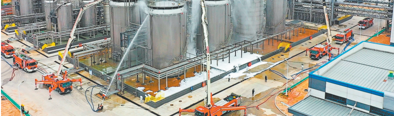
演练现场，举高喷射消防车凭借五节折叠臂架升至62米高空，精准打击火情。
