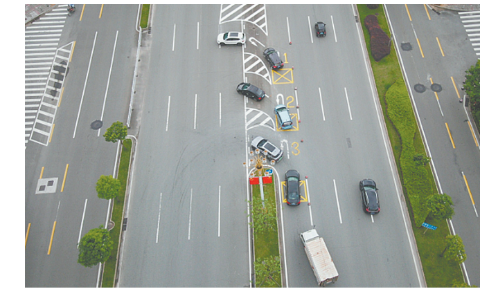
“多车串联掉头”可同时容纳3辆车进行掉头操作，有效提高通行能力。
