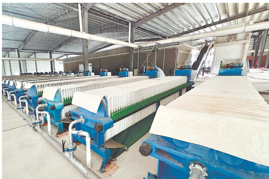
压滤机作为友顺新材料工厂中自动化程度最高的核心设备，是企业提质增效的关键。
