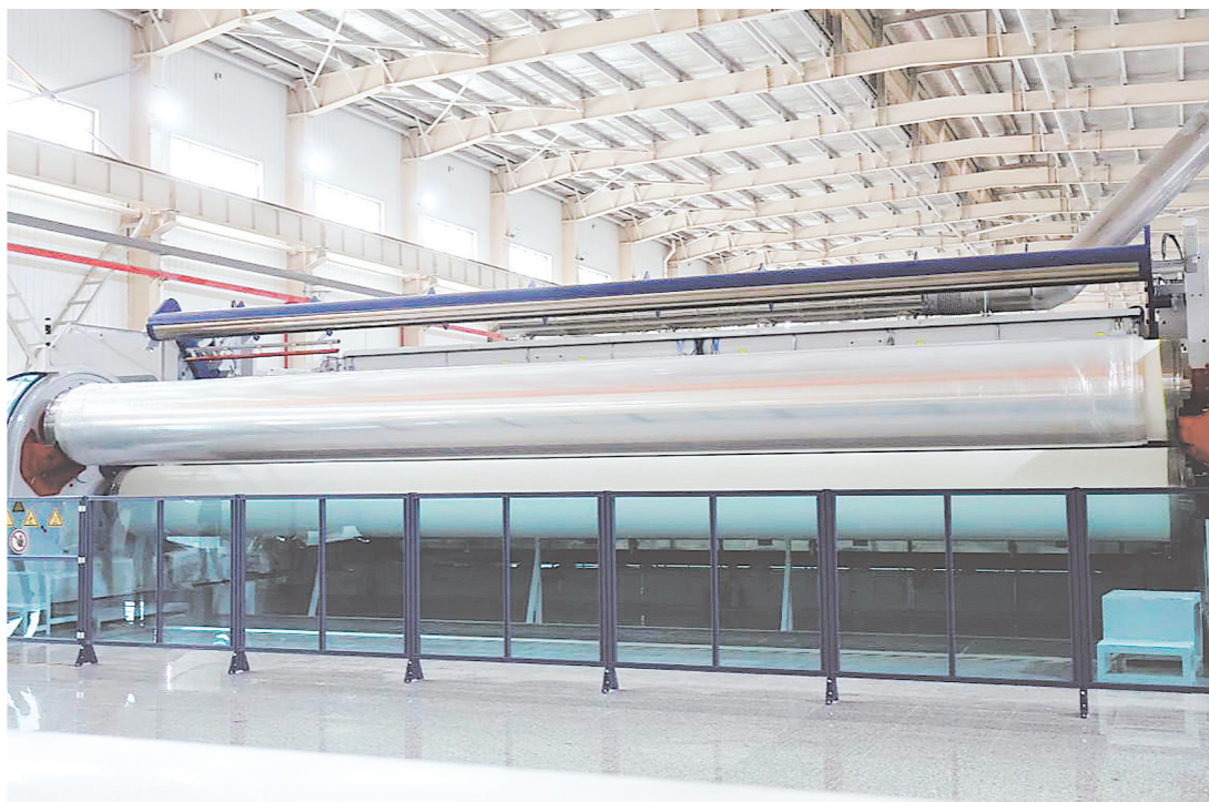
友谊新材料首条德国布鲁克纳BOPP生产线能以700米/分钟的行业顶尖速度高效运行,年产能达6万吨。
