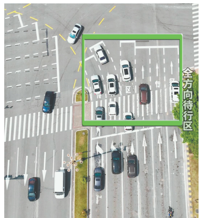
通过设置应用全向待行区,江侨路汽车总站路口通行车辆平均排队长度缩短30.86%。
