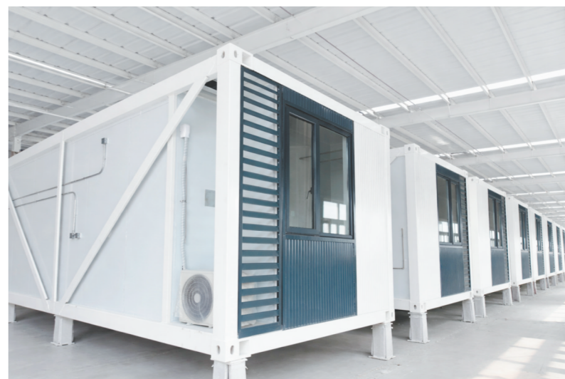
这些模块运往印尼后,将组装成单体建筑。图片来源:中集模块化建筑
