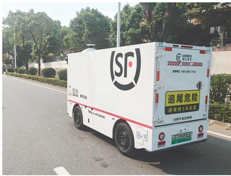
搭载多传感器融合感知系统的无人配送车在道路上平稳行驶。
