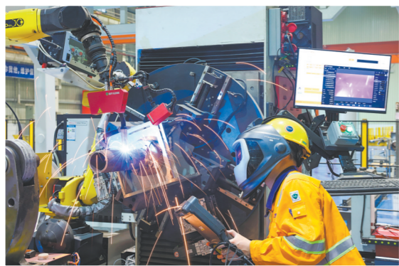
技术人员在深水油气装备工艺管线智能生产线调试智能焊接系统的焊接工艺。
