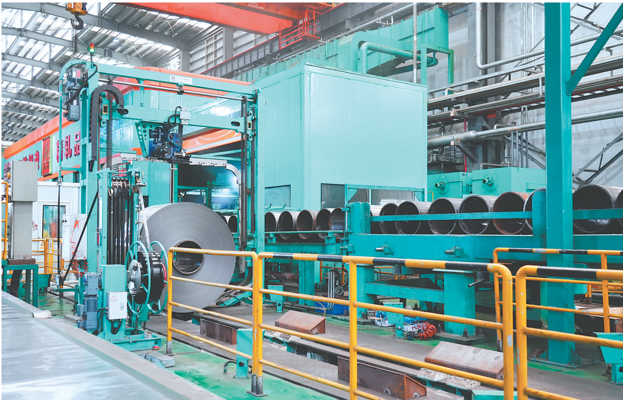
鹤山华美金属引进1250毫米高端智能六机架酸连轧机组，目前已实现冷轧薄板的稳定量产，最薄的轧制规格可达到0.14毫米。
