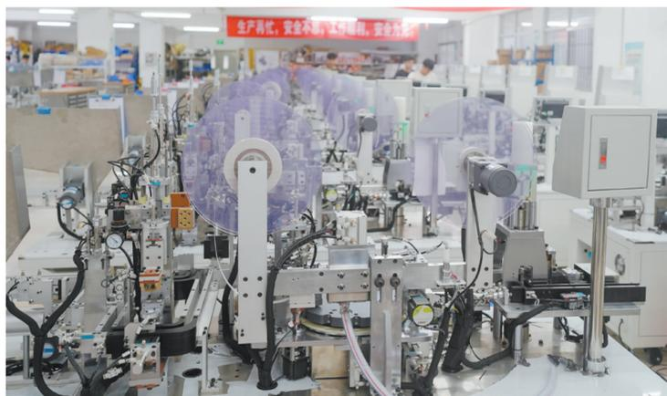
南大机器人圆柱锂电池智造装备正进行着自动化运作。
