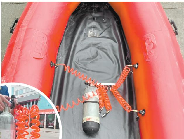
↑“便捷式快速充气装置”能够减少操作步骤,给多个气囊快速充气。
