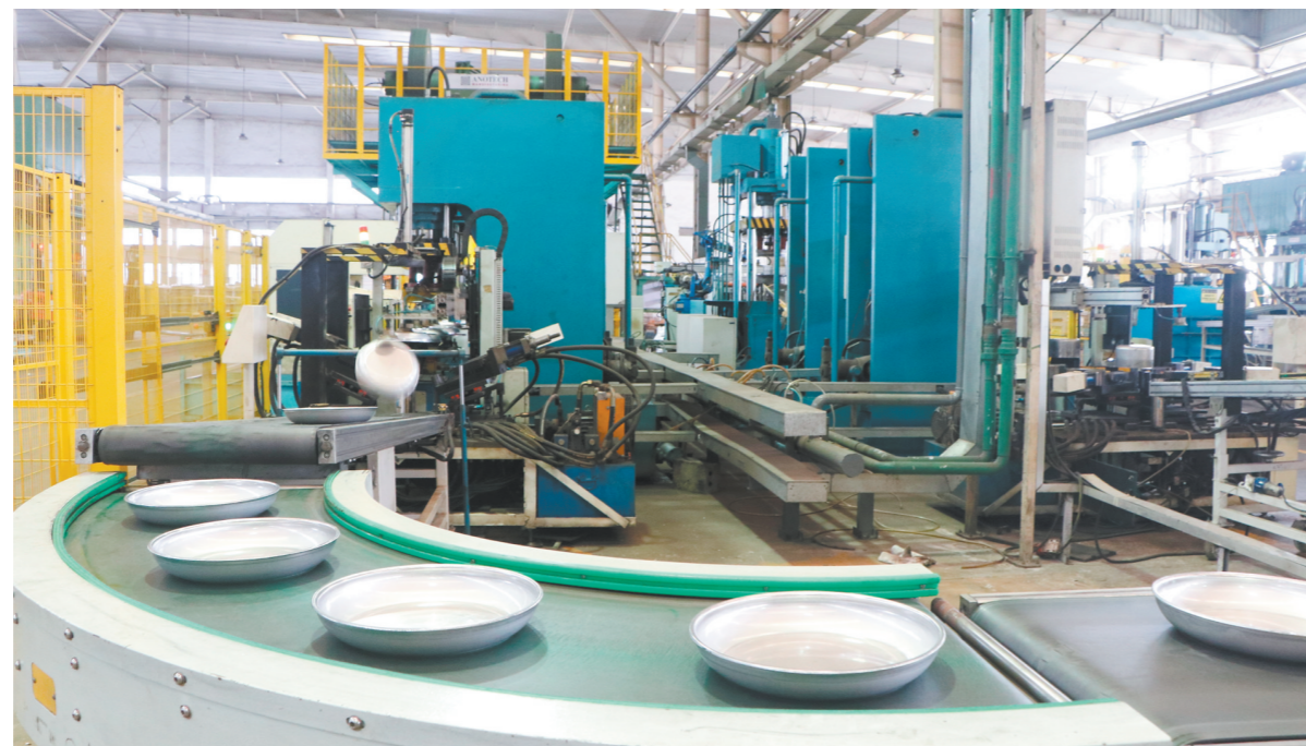
江门市安诺特炊具制造有限公司开展技改后,高档西式炊具生产实现了自动化、智能化。
