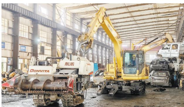
工作人员利用多功能拆解机、切割机等设备对报废农机进行精细化拆解。
