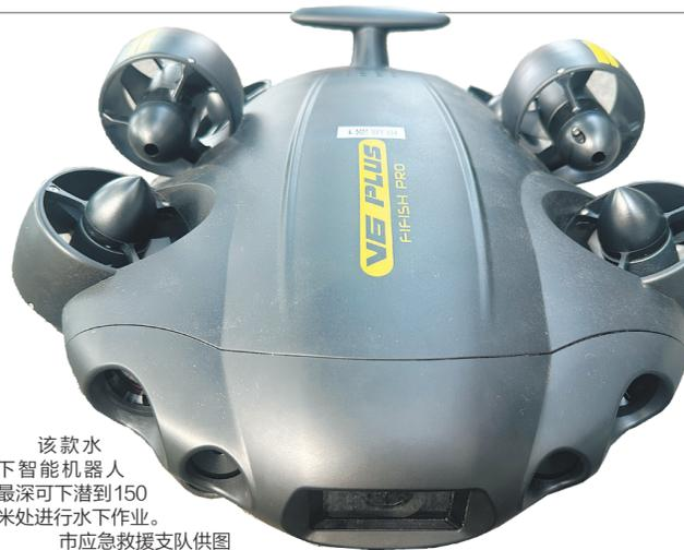
该款水下智能机器人最深可下潜到150米处进行水下作业。市应急救援支队供图
