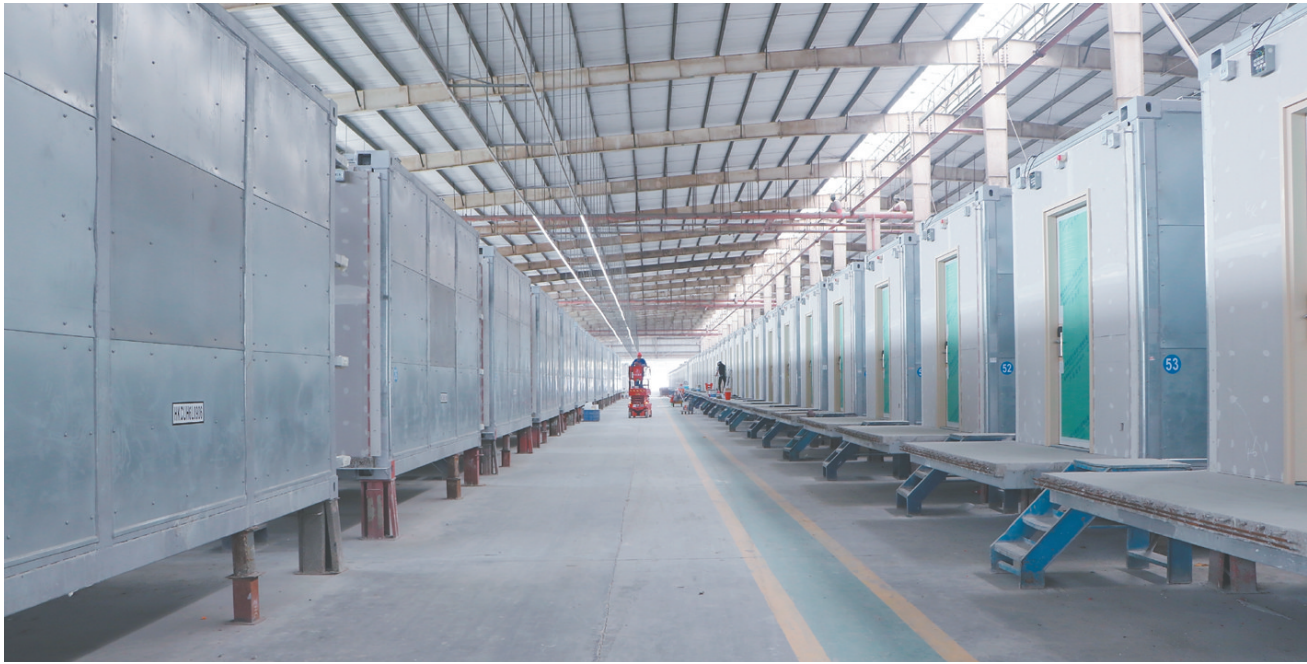
中集模块化建筑产品的工厂预装率已超90%，助力施工工期压缩50%以上。
