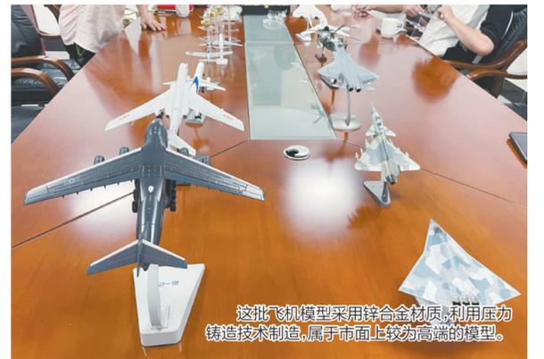
这批飞机模型采用铝合金材质,利用压力铸造技术制造,属于市面上较为高端的模型。
