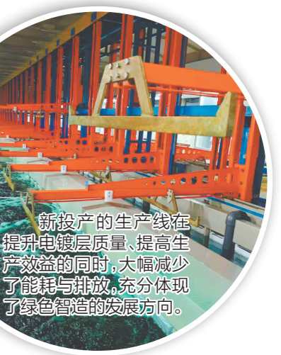
新投产的生产线在提升电镀层质量、提高生产效率的同时,大幅减少了能耗与排放,充分体现了绿色智造的发展方向。
