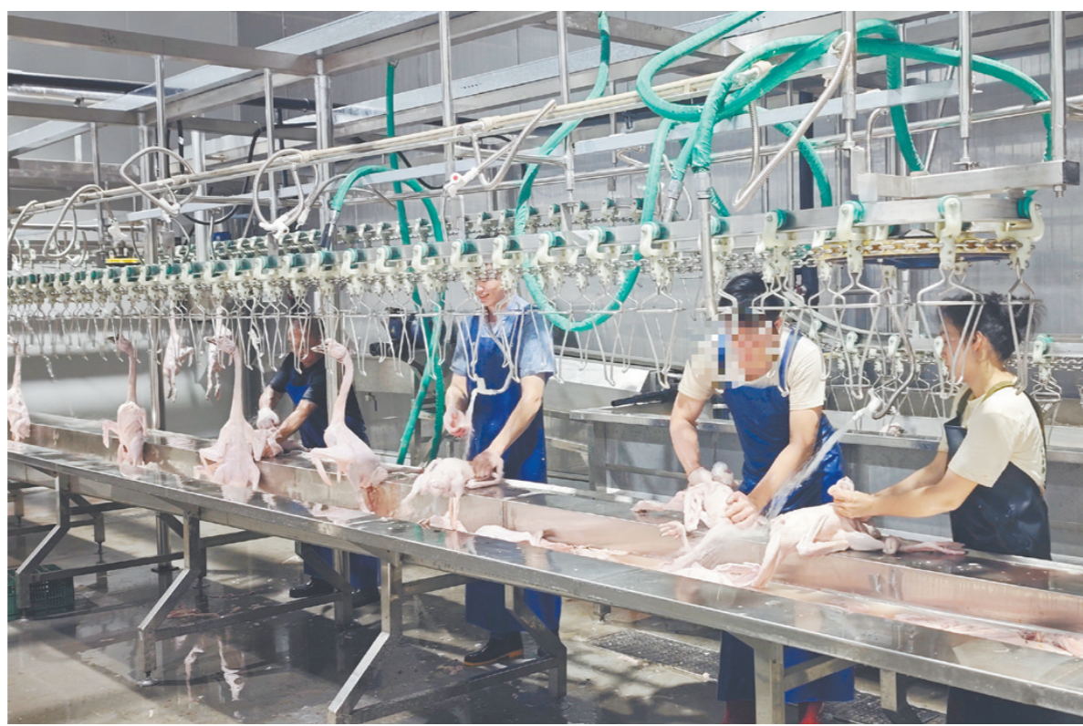
屠宰车间三条生产线设计年屠宰总能力达1000万羽,鸭鹅生产线全部产能可适配马冈鹅屠宰。
